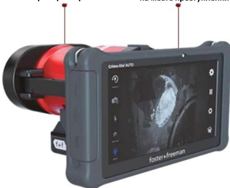
Встроенный 7-дюймовый мультисенсорный дисплей с программным обеспечением для съемки на месте преступления
